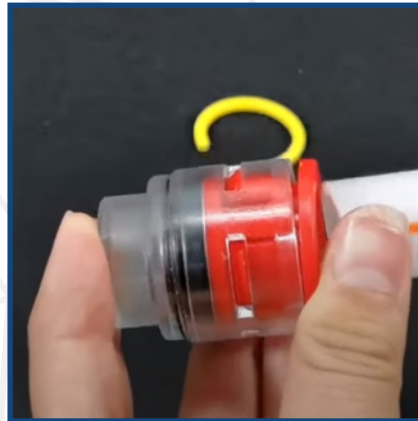
2. Presione la pestaña de un extremo e inserte el microducto asegurándose que llegue al tope
